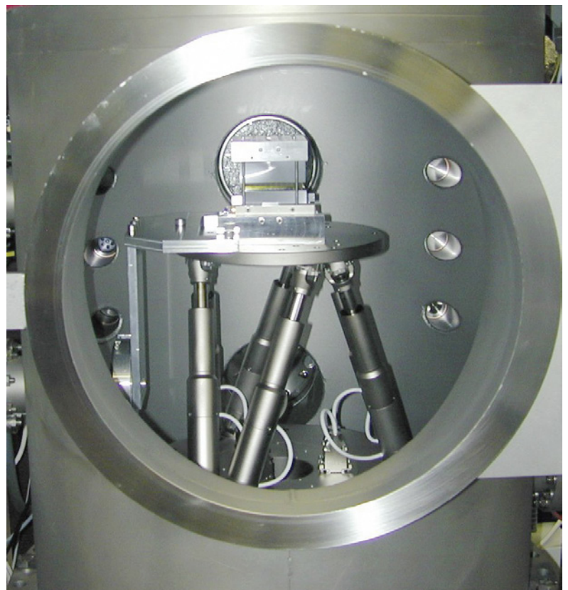
Bild 4. Oben: Silizium-Poren-Optik (SPO), die aus gestapelten Wafern mit Rippen auf der Unterseite besteht. Unten: SPO auf dem Hexapod der X-ray Pencil Beam Facility (XPBF).
