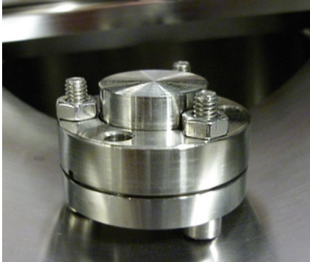
Kleinste Ausführung (Durchmesser 34 mm) einer Referenzausgasungsprobe für Wasserdampf mit 6 \cdot 10^{-7} mbar L/s
